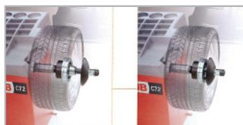
**MÉCANISME DE BLOCAGE PNEUMATIQUE DE LA ROUE.**
